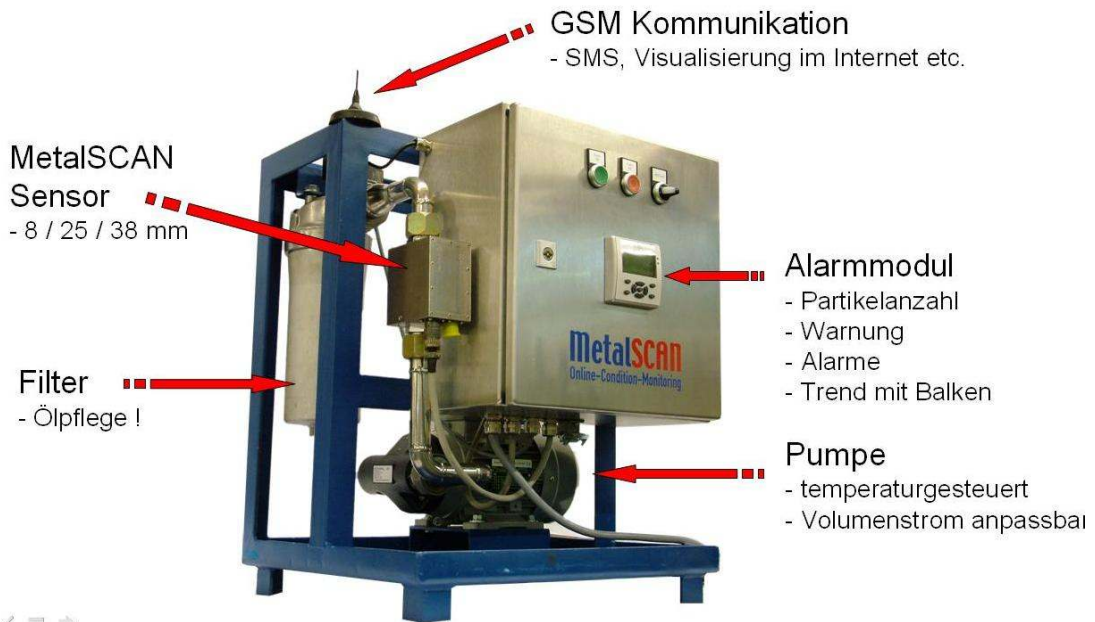
Bild 5: MetalSCAN All-In-One Filteraggregat mit Pumpe, Filter, Sensor, Alarmmodul und GSM-Kommunikation
