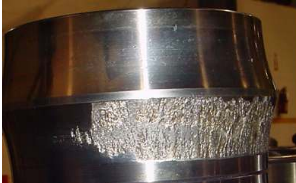
Bild 12: Schaden am Planetenlager, Innenring und Laufkörper
